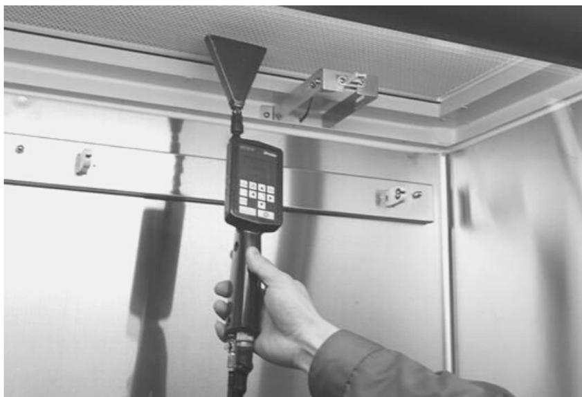
Il metodo utilizzato è l'Aerosol Challenge Method descritto in dettaglio nell'allegato D della norma EN 12469 a cui si rimanda per i dettagli.
