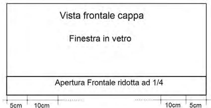
Nella immagine è riportato un tipico diagramma di esecuzione del test di verifica della barriera frontale. Il test è effettuato secondo quanto indicato dalla norma EN 12469 allegato G.5 a cui si rimanda per i dettagli. Per buona prassi la verifica della barriera frontale di protezione dovrebbe essere effettuato all'atto della prima installazione e successivamente con cadenza annuale.
